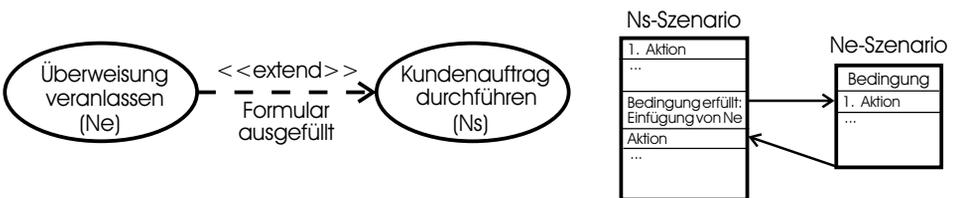
**Abbildung 5.2-6:** Erweiterungsbeziehung zwischen Nutzungsfällen (*extend*-Beziehung)
