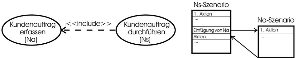
**Abbildung 5.2-5:** Einfügungsbeziehung zwischen Nutzungsfällen (*include*-Beziehung)
