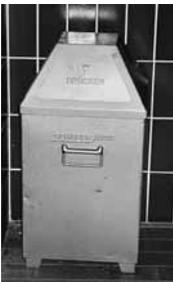
**Bild 3:** Geeigneter Abfallbehälter: Sammelbehälter für Putzlappen, entzündbare Abfallstoffe etc. Durch die selbsttätig schließende Klappe wird die Sauerstoffzufuhr unterbunden. (Tretzel)
