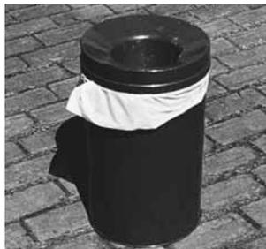
**Bild 4:** Geeigneter Abfallbehälter: Durch die Konstruktion des aus Blech gefertigten Papierkorbs werden aufsteigende Verbrennungsgase wieder nach unten geleitet. Dadurch wird die Sauerstoffzufuhr abgeschnitten. (Tretzel)
