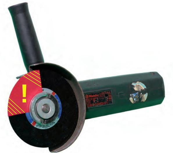
**Bild 2:** *Der gekennzeichnete Bereich der Trennscheibe darf nicht zum Trennen benutzt werden. Es droht Rückschlaggefahr! (Foto: Christian Folge)*
