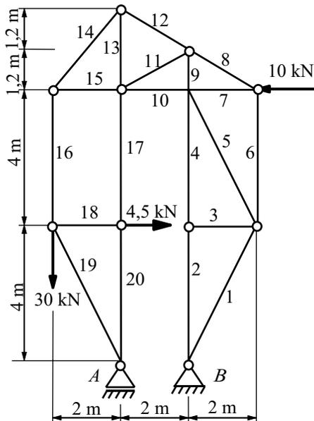
Abb. 6.2.1: Als Stabwerk idealisierter Baukran.
