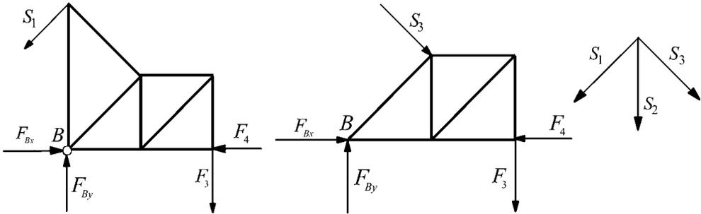
Abb. 6.1.3: Schnitte zur Ermittlung der Stabkräfte.
