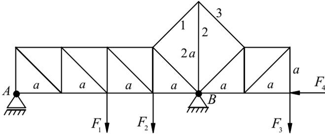
Abb. 6.1.1: Als Stabwerk idealisierter Baukran.
