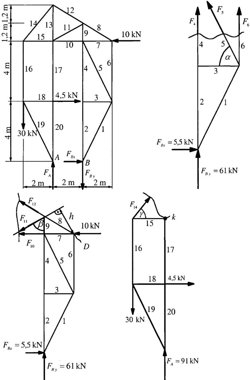
Abb. 6.2.2: Schnitte am Stabwerk.
