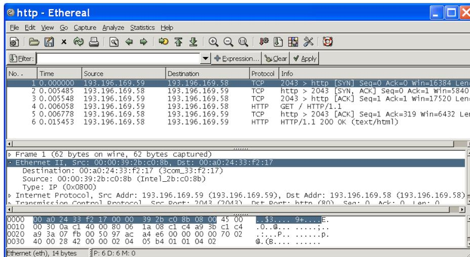
Mit *Wireshark* bzw. *Ethereal* können Rahmen aufgezeichnet und analysiert werden. Im oberen Fensterbereich werden alle empfangenden Rahmen mit Zeitstempel aufgeführt. Der markierte Rahmen wird im unteren Fensterbereich hexadezimal und in ASCII angezeigt. Im mittleren Fensterbereich kann man einzelne Bereiche des Rahmens auswählen und erhält spezifische Informationen (Ethernet-Adressen, Typ usw.).
