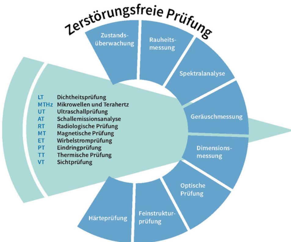
**Bild 1.1** Gegenstandsbereich und Methoden der Zerstörungsfreien Prüfung (Quelle: DGZfP 2018)
