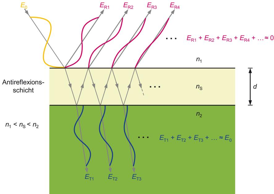
**Bild 3.24** Wirkungsweise der Antireflexschicht: Die reflektierten Lichtwellen löschen sich gegenseitig aus, da die erste Reflexion um  $180^\circ$  phasenverschoben zu den restlichen Reflexionen ist. Dagegen überlagern sich die transmittierten Strahlen phasengleich, so dass im optimalen Fall die ursprüngliche Bestrahlungsstärke  $E_0$  vollständig im Halbleiter ankommt.
