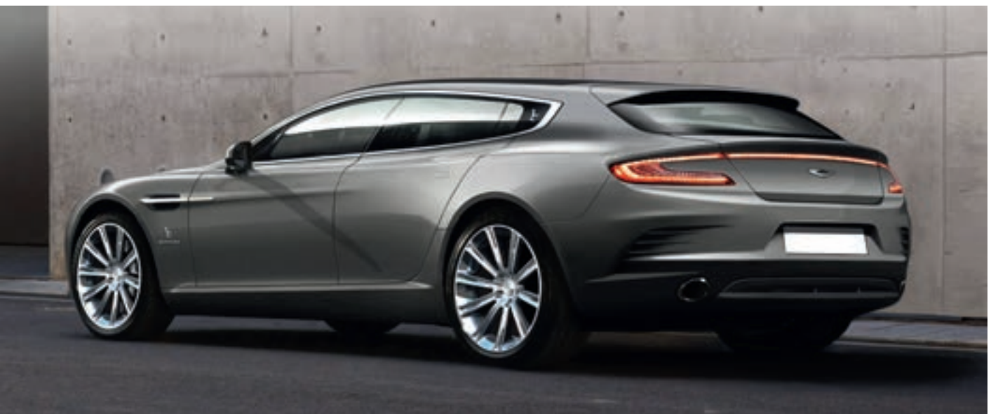
Die Heckklappe des Jet 2+2 zeigte markante, bis in die Seitenflächen eingebogene Prägungen, die auch die Heckleuchten umfassten. Der Dachabschluss trug eine kurze Abrisskante (bw).
