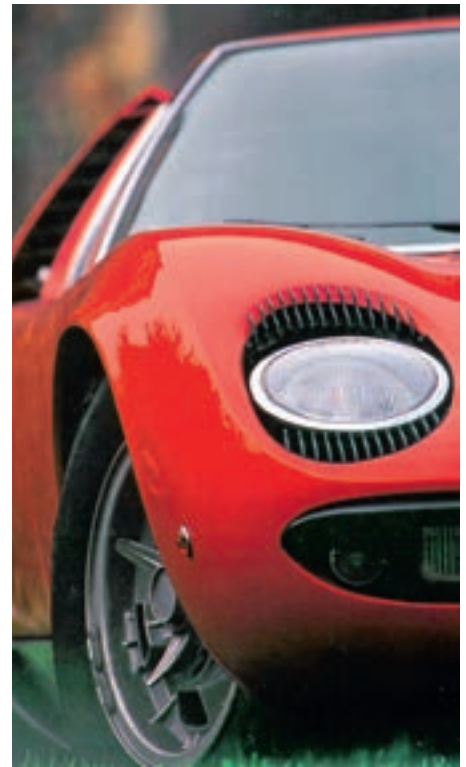
Die Scheinwerfer mit einer Art Augenwimpern klappten nach vorne aus der Karosserie (wb).
