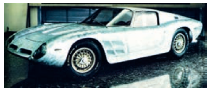
In der Bertone-Werkstatt 1963: die Alu-Rohkarosserie der leichtgewichtigen Rennsportvariante Iso Grifo A3 C mit verkürztem und mit Stahlrohren verstärktem Unterbau (1150 kg; mit Corvette-V8 bis 305 km/h- iw).
