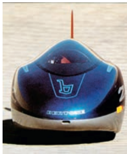
Dank extremer Aerodynamik kam der ZER auf eine Stirnfläche von bloß 0,62 m 2 (bw).
