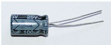
Abbildung 1.3: Ein Elektrolytkondensator mit Kapazitätsangabe und Maximalspannung
