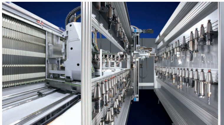
2 Hintergrundwerkzeugmagazin mit Linearroboter für ca. 200 Werkzeuge
