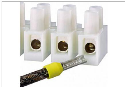
**Abbildung 4-33:** Lüsterklemmen aus dem Baumarkt sind kaum für den Bordeinsatz geeignet. Der Leiter wird mit einer Schraube festgeklemmt, so dass die Verbindung abhängig von der Anzugskraft ist, und die Schrauben können rosten. (Conrad)
