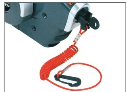
**Quickstopp** – ein Muss für jeden Außenborderfahrer. Angeklickt verbindet er Mensch und Schaltkasten oder Motor. Beim Sturz (über Bord) wird die Zündung unterbrochen, und der Motor kommt sofort zum Stillstand.
