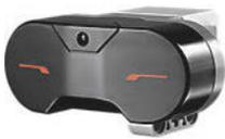
Abb. 10.3: Der Infrarotsensor
