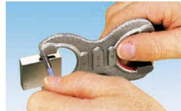
**Bild 4: Prüfen von Rachenlehren mit Endmaß und Prüfstift**
