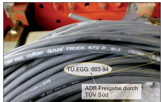
Bild 2: Leitung mit ADR-Freigabe
