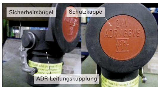
Bild 3: ADR-Leitungskupplung nach IP 54
