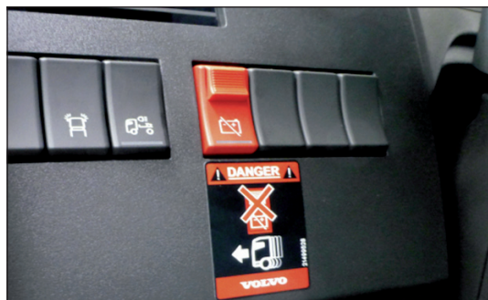
Bild 1: Not-Aus-Schalter im Fahrerhaus
