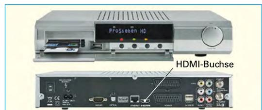
**Bild 3: Satellitenreceiver: Vorder- und Rückansicht**
