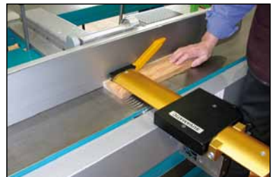
Bild 5: Betriebliche Sicherheitseinrichtung, Messerwellenabdeckung bei einer Abrichthobelmaschine
