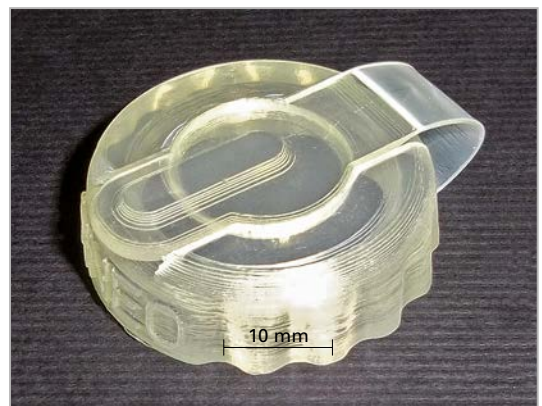
Bild 2: Im LLM-Verfahren hergestelltes Anschauungsmodell
