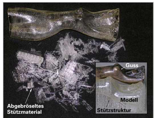
Bild 2: Entfernen der Stützstruktur
