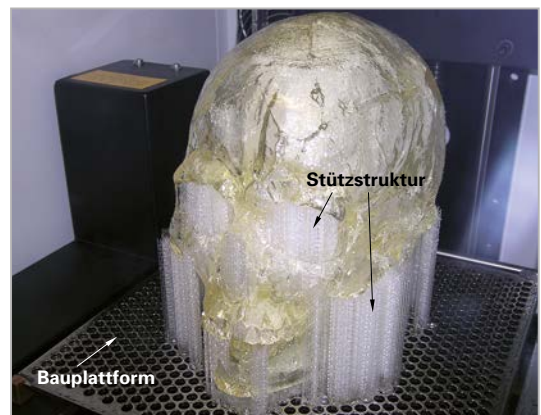
Bild 3: Feste Verbindungen mit der Bauteilplattform
