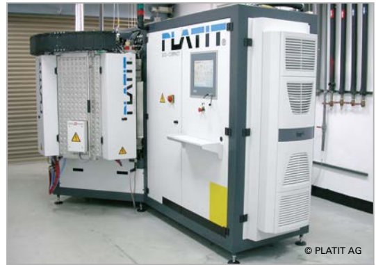
Bild 2: PVD-Beschichten mit Sputter-Anlage
