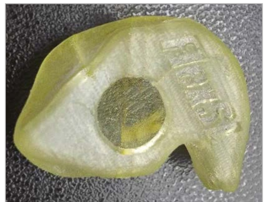
Bild 3: Im Stereolithographieverfahren hergestellte Gehörkapsel
