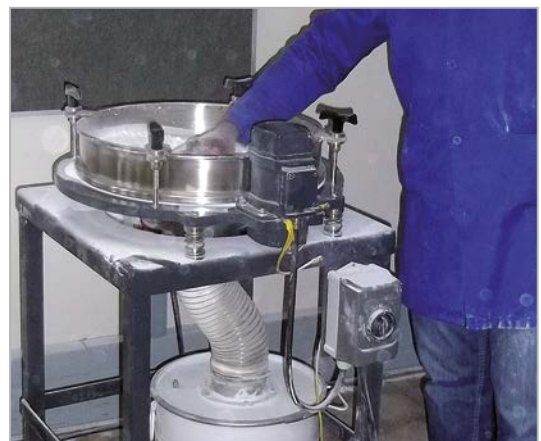
Bild 3: Kunststoffpulveraufbereitung in Siebstation
