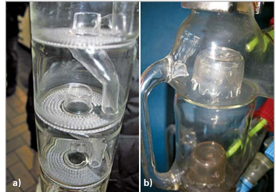
Bild 2: Laborkolonnen, a) mit Siebböden, b) mit Glockenböden
