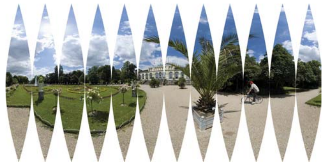
Abbildung 1.15 Das dreidimensionale »Kugelfoto« wird nach diesem Schnittmuster imaginär aufgeschnitten, in die zweidimensionale Ebene ausgebreitet und horizontal gezogen, damit keine Leerstellen verbleiben. Das Resultat ist ein equirektangulares Panoramafoto.
