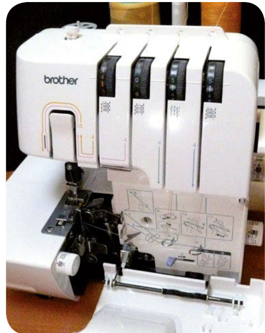
Farbcode der Overlock Brother 3034D: Jeder Faden hat seine Farbe. Die Arbeitsschritte sind direkt auf der Maschine nummeriert – Einfädeln leicht gemacht!
