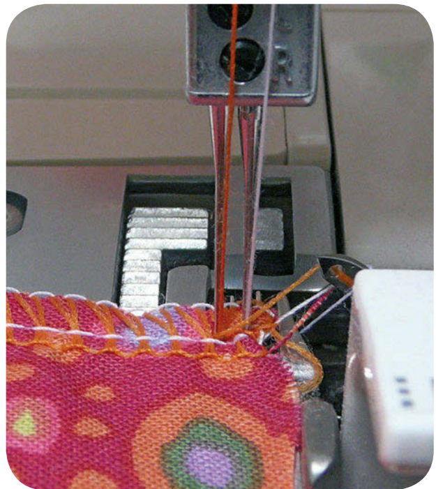
Bild 2 – Der Nähfuß wurde entfernt, damit zu erkennen ist, wo die Nadeln in den Stoff einzustechen sind.
