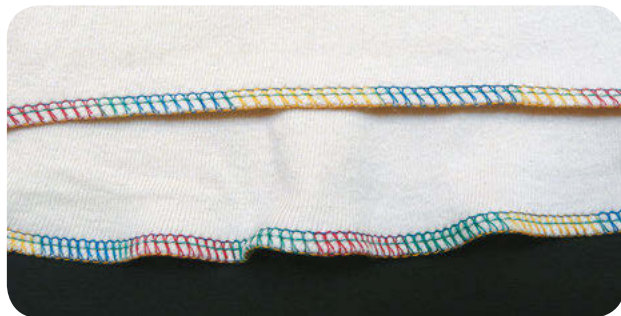
Bild 1 – Oben: korrekte Einstellung des Differenzials; unten: zu niedrige Einstellung
