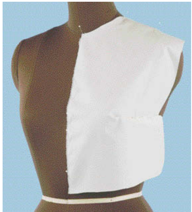
Mit Abnäher steht der Stoff nicht mehr vom Körper ab.
