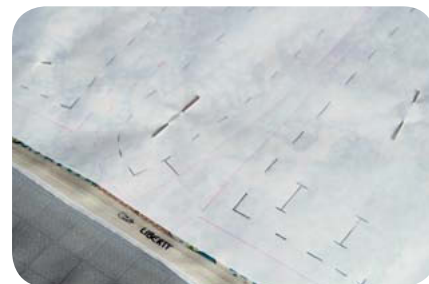
Der Crêpesatin liegt zwischen zwei Bogen Papier und wird gemäß den auf das obere Papier gezeichneten Schnittteilen zugeschnitten.
