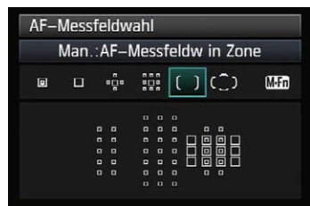
Bei der »AF-Messfeldwahl« in Zone können Sie die Messfeldgruppe in insgesamt neun unterschiedliche Zonen bewegen.
