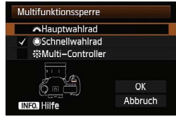
Wenn der Multicontroller mit ausgewählt ist, wird er über den Schalter Lock gesperrt.
