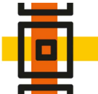
In der schematischen Vergrößerung sieht man, dass nur der Spot-AF sich wirklich auf die reine Kreuzungsfläche beschränkt, in dem größeren Feld liegen Bereiche, die nur noch von einem Liniensensor abgedeckt werden.
