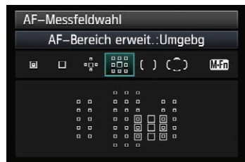
»AF-Bereich erweitert: Umgebung« bezieht auch die diagonal vom Hauptfokusfeld gelegenen AF-Felder mit ein.
