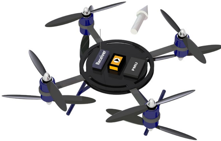
Abb. 1–12 Quadrocopter mit Koaxialantrieb
