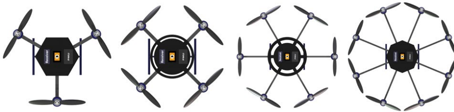
Abb. 1–10 Die häufigsten Bauformen von Multicoptern
