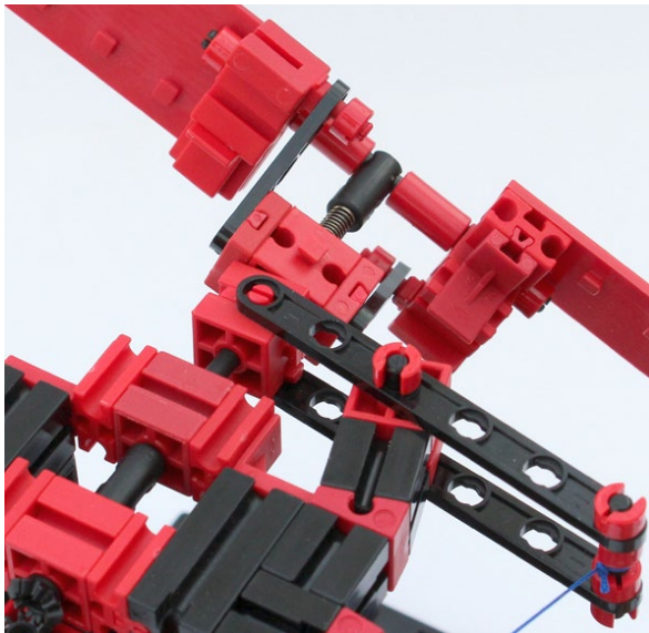
Abb. 16–10 Steuerung des Anstellwinkels der Heckrotorblätter (Pitch)
