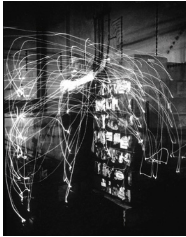
Effizienzstudie, Frank und Lilian Gilbreth, 1918 // Wie schon Demenÿ und Marey machten die Gilbreths Lichtmalerei-Aufnahmen zur wissenschaftlichen Forschung und nicht der Kunst wegen. Ihr Ziel war es, die Arbeitsbedingungen durch Effizienzsteigerungen zu verbessern.
