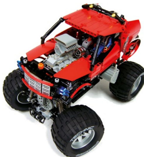
Abbildung 3-1: Bei meinem Monster-Truck-Modell folgte ich der Vorgehensweise der modernen LEGO-Technic-Bausätze: Die Konstruktion ist fast vollständig noppenlos, wobei einige Noppenbauteile zusätzlich für kleine Details verwendet wurden, z. B. für den Kühlergrill.
