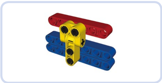
Abbildung 3-43: Kombination zweier Verbinder (gelb) zur mittigen Ausrichtung eines sechs Noppen langen Teils (rot) an einer sieben Noppen langen Struktur (blau)
