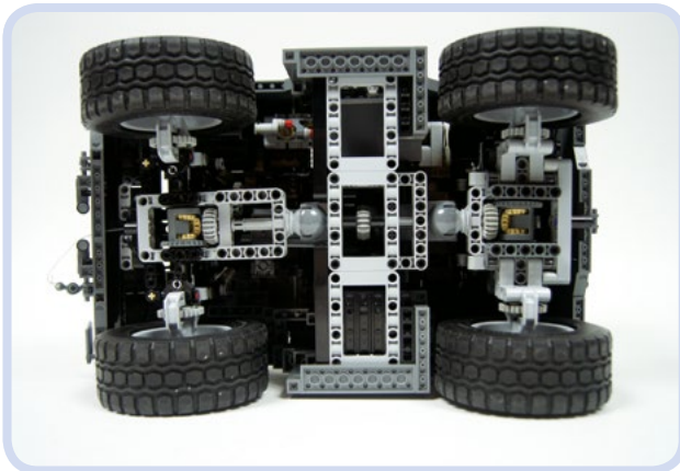
Abbildung 3-29: Mein Modell des RG-35 4x4 MRAP (ein gepanzerter Mannschaftstransporter) weist ein komplett noppenloses Chassis und eine Karosserie ganz aus Noppenelementen auf. Das realistische Modell ist äußerst kompakt, die dichte Bauweise der Karosserie machte es jedoch kopflastig.
