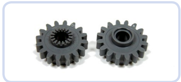
Abbildung 6-19: Die ursprüngliche Varianten des Zahnrads mit 16 Zähnen (links) hatte Zähne rund um die Öffnung, die neue Version (rechts) ist glatt.
