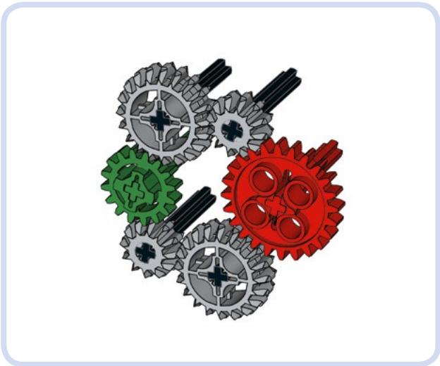
Abbildung 6-8: Alle mittleren Zahnräder in diesem Bild sind Laufräder. Sie haben keinen Einfluss auf die Umwandlung von Drehmoment und Drehzahl zwischen dem Antriebsrad und dem angetriebenen Rad.
