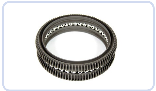
Abbildung 6-23: Diese Drehscheibe besteht aus zwei Hailfire-Droid-Rädern. Zum Auffüllen sind 41 LEGO-Standardkugeln erforderlich.
