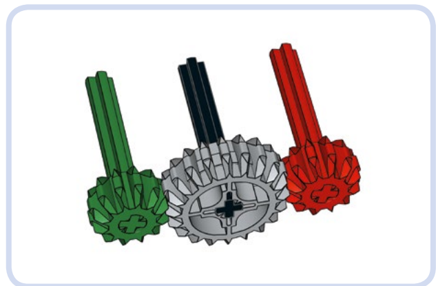
Abbildung 6-5: Drei ineinandergreifende Zahnräder. Die Achse des grau dargestellten Laufrads dient nur zu dessen Befestigung.
