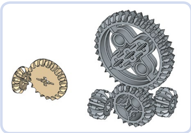
Abbildung 6-13: LEGO-Kegelräder und ihre Verzahnungsmöglichkeiten. Einzelkegelräder sind beige dargestellt, Doppelkegelräder hellgrau. Einzelkegelräder sehen nicht nur so aus wie halbierte Doppelkegelräder, sondern funktionieren auch so.
