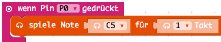
Abb. 3–8 Programmierbefehle zum Erzeugen eines Tons bei Drücken des Gegenstandes an Pin P0
