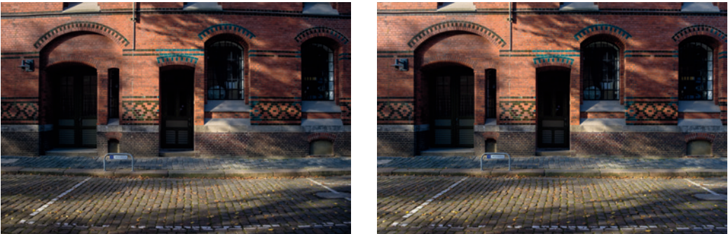
Abbildung 7: Dieses Beispiel wurde mit einer X100F und dem Weitwinkelkonverter WCL-X100 aufgenommen. Im linken Bild wurden die Metadaten der digitalen Objektivkorrektur ignoriert. Dadurch kommt es zu einer sichtbaren tonnenförmigen Verzerrung, die durch den WCL verursacht wird. Das Bild rechts zeigt die gleiche Aufnahme, diesmal jedoch mit digitalen Objektivkorrektur-Metadaten, die von kompatiblen RAW-Konvertern wie Adobe Lightroom automatisch übernommen werden.
