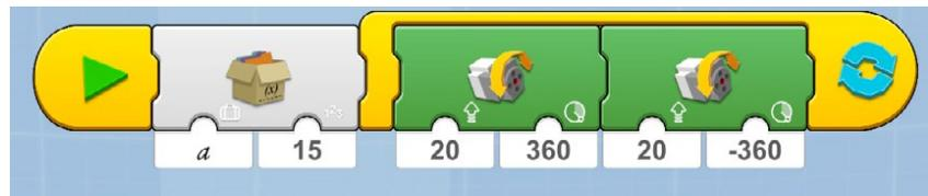
Das Programm besteht aus drei verschiedenen Abläufen. Der obere Programmteil ist nur dafür da, den Sensor immer hin und her zu bewegen. Außerdem haben wir hier zur Demonstration eine Variable eingebaut. Ganz am Anfang wird diese auf den Wert »15« gesetzt (also eine »15« in den Kasten »a« gelegt). Das wird bei den nächsten beiden Programmen noch wichtig.
