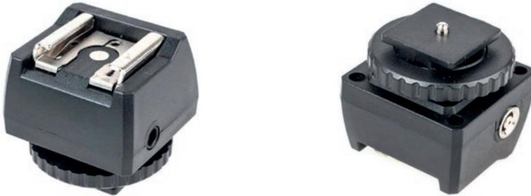
Abbildung 64: Bekommen Sie Überhitzungswarnungen, nachdem Sie inkompatible TTL-Blitzgeräte an Ihre X-Kamera angeschlossen haben? Ein preiswerter und einfacher **Mittelkontakt-Blitzschuhadapter** trennt das Triggersignal von unerwünschten TTL-Signalen.
