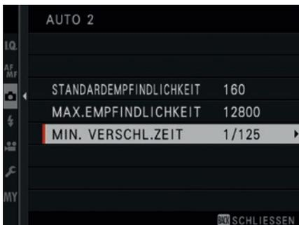
Abbildung 103: **Auto-ISO** arbeitet mit einem ISO-Bereich zwischen STANDARD-EMPFINDLICHKEIT (der Mindestwert) und MAX.EMPFINDLICHKEIT (der Maximalwert). Es wird immer versucht, ISO so nah wie möglich am Mindestwert zu halten – jedoch nur so lange, wie die resultierende Verschlusszeit nicht länger ist als die unter MIN.VERSCHL.ZEIT eingestellte Zeit.
