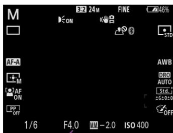
Abbildung 4.24: Im manuellen Modus M stellen Sie mit dem vorderen Drehrad **1** die Blende und mit dem hinteren Drehrad **2** die Belichtungszeit ein (Bild: Sony). Auf dem Monitor bzw. im Sucher können Sie jederzeit die aktuell eingestellte Blende **3** ablesen.
