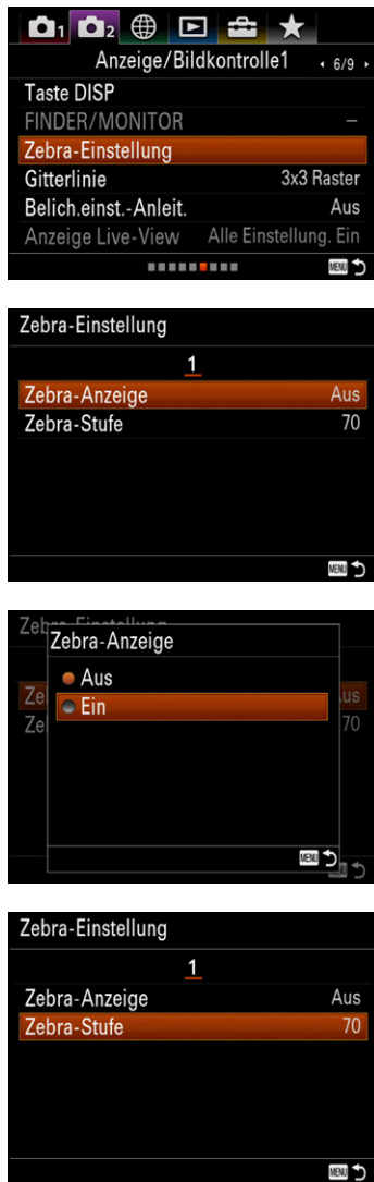
Abbildung 15.11: Die Funktion »Zebra« kann Sie beim Filmen unterstützen und hilft, überbelichtete Bereiche während des Filmens schnell zu erkennen.
