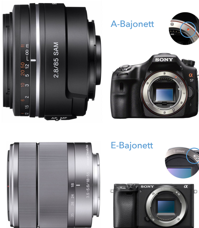
Abbildung 9.11: Die Objektive mit Sonys A-Bajonett sind nicht kompatibel mit dem Ihrer a6400. Diese verfügt über das E-Bajonett. Mit einem Adapter können Sie die A-Bajonett-Objektive allerdings verwenden, ebenso wie viele Fremdobjektive ohne E-Bajonett.
