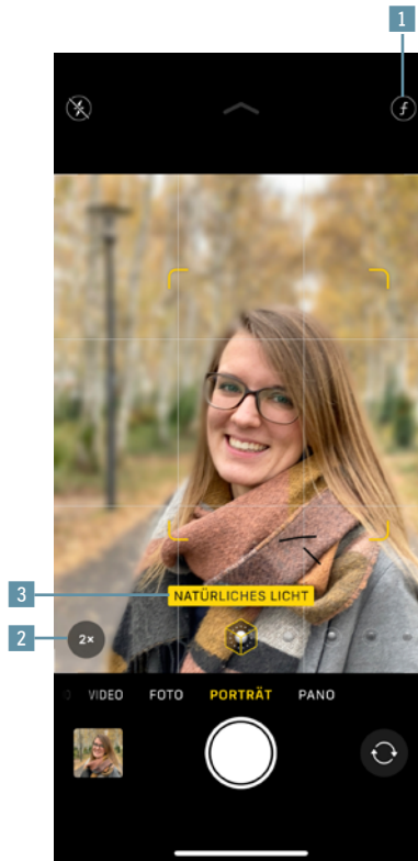
Abbildung 3.14: In der Kamera-App können Sie vor der Aufnahme im »Porträt«-Modus den Unschärfe-Effekt 1 wählen. Nutzen Sie ein iPhone 11 Pro, dann haben Sie die Wahl zwischen der Weitwinkel- oder der Tele-Kamera 2 ; beim iPhone 11 sind Sie auf die Weitwinkel-Kamera beschränkt. Wischen Sie horizontal über die Beleuchtungseffekte 3 , um sie zu ändern.
