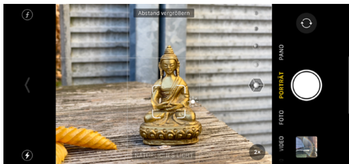
Abbildung 3.13: Für den »Porträt«-Modus müssen Sie einen höheren Mindestabstand zum Motiv einhalten als bei einer normalen Aufnahme. Mit einem iPhone 11 können Sie sich bis auf rund 23 cm nähern. Das iPhone 11 Pro erlaubt zusätzlich eine Porträtaufnahme mit dem Tele-Objektiv. Hier beträgt der Mindestabstand ca. 40 cm – etwa eine Armlänge. Die Kamera-App zeigt Ihnen an, ob der Abstand zu gering ist.
