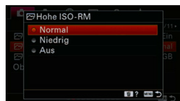
Abbildung 2.13: Bei höheren ISO-Werten verringert die Option »Hohe ISO-RM« das Rauschen in den Bildern der a6100.
