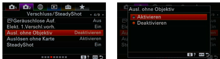
Abbildung 2.14: Standardmäßig ist das Auslösen ohne bzw. mit adaptiertem Objektiv möglich.
