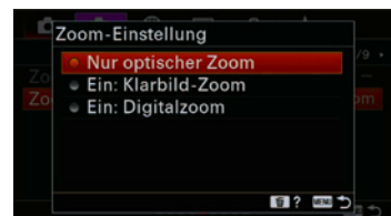
Abbildung 2.16: Mit »Klarbild-Zoom« und »Digitalzoom« können Sie Objekte näher heranziehen. Allerdings müssen Sie Abstriche bei der Bildqualität machen.
