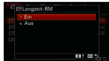
Abbildung 2.12: Bei Belichtungszeiten über einer Sekunde kommt die Rauschminderung »Langzeit-RM« zum Einsatz.
