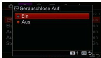
Abbildung 2.7: Ob Sie ein Verschlussgeräusch wünschen oder nicht, ist sicherlich Geschmackssache. Bedenken Sie aber, dass es bei abgeschaltetem mechanischen Verschluss bei bewegten Motiven zu Verzerrungen und Streifen auf dem Bild kommen kann.
