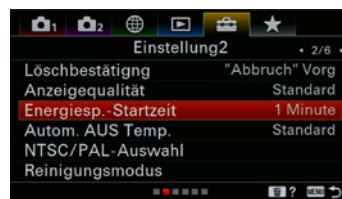
Abbildung 2.5: Wollen Sie Strom sparen, dann wählen Sie eine kurze Zeit bis zur Autoabschaltung der a6100.
