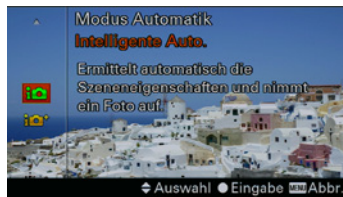
Abbildung 6.1: Wählen Sie mit dem Moduswahlknopf die Option »AUTO«, dann stehen Ihnen im Menü die beiden Automatikprogramme »Intelligente Auto.« oder »Überlegene Autom.« zur Verfügung.
