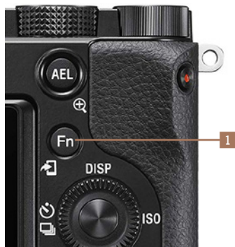
Abbildung 1.12: Schnell auf wichtige Funktionen zugreifen: Das gelingt Ihnen mit der Fn-Taste 1 (Foto: Sony).
