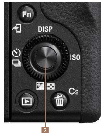
Abbildung 1.10: Einstellrad 3 der α6100 mit Direktwahlfunktionen (Foto: Sony)
