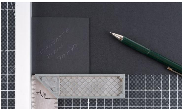
*Ein Musterstück und ein exakter Anschlag ermöglichen es, die Form gleicher Bauteile präzise und schnell zu übertragen.*
