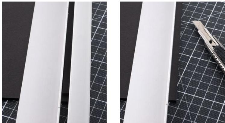
Abstand zum Rand des Werkstücks zu positionieren, legt man das Werkstück zuerst an eine Aluleiste an. Dann legt man das Muster als Distanzstück auf und kann jetzt das Schneidelineal exakt positionieren. Zum Schneiden entfernt man Aluleiste und Distanzstück wieder. So lassen sich ohne erneutes Abmessen und Einzeichnen beliebig viele gleiche Streifen herstellen.
