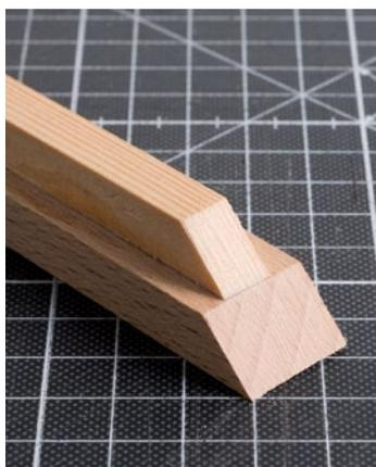
*Die einzelnen Leisten werden mithilfe von Distanz- und Anschlagleisten miteinander verleimt. Damit sich die Hilfsleisten wieder lösen lassen, werden sie vor dem Verleimen mit transparentem Klebeband versehen. Das Ergebnis ist eine individuelle Profilleiste.*
