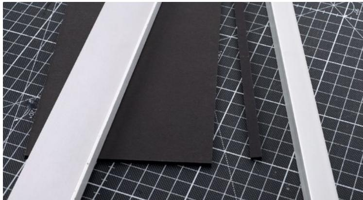
*Das Musterstück dient als Abstandstück zwischen Schneidelineal und Aluleiste. Zum Schneiden werden Musterstück und Aluleiste wieder entfernt.*
