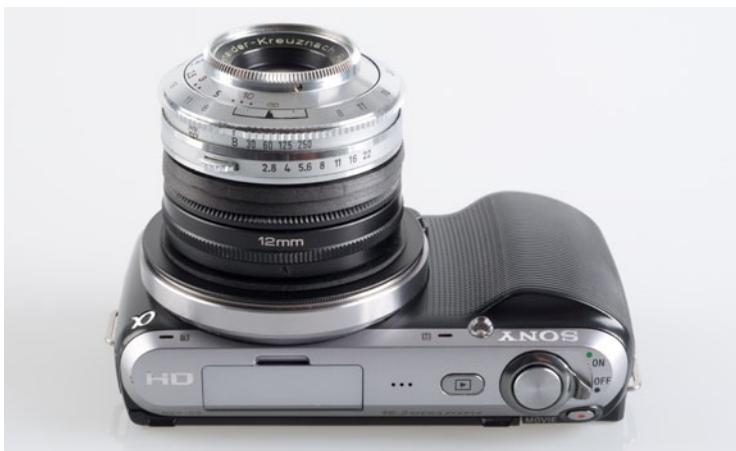
Hat man keinen Helicoid zur Verfügung, kann der Aufbau des Adapters auch schichtweise erfolgen. Von oben nach unten: Objektiv, zwei Zwischenplatten à 3 mm, M42-Kameradeckel, 12-mm-Zwischenring, 1-mm-Gummiring, Adapter von Kamerabajonett auf M42.
