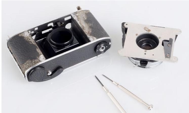
*Jetzt kann man mit einem speziellen Objektivschlüssel die Kontermutter lösen und Objektiv und Trägerplatte trennen.*
