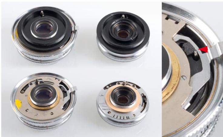
Bei manchen Objektiven liegt der Verschluss-Spannhebel weiter innen, und man kann direkt einen M42-Kameradeckel mit einer passenden Bohrung versehen. So erhält das Objektiv einen Anschluss an weiteres M42-Zubehör, etwa einen Helicoid oder einen Zwischenring. Links: Agfa Super Silette, rechts: Agfa Silette, Detailbild: gekürzter Auslösehebel, mit einem Stück Kunststoff blockiert.
