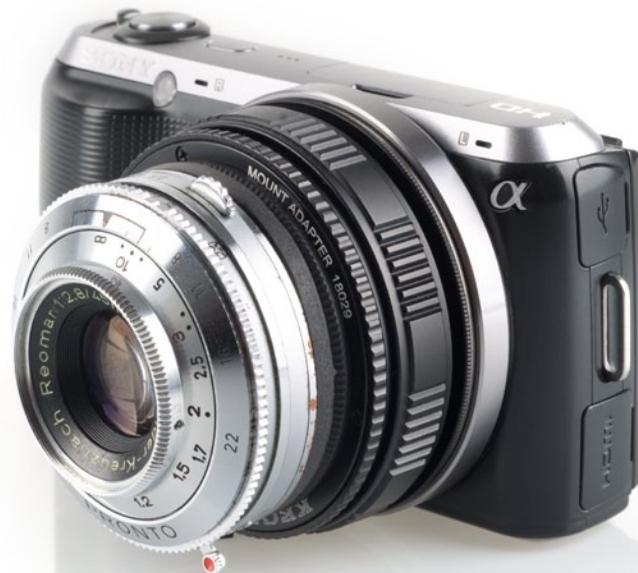
*Das Schneider-Kreuznach Reomar 1:2,8/45 mm, hier mit einem Helicoid, an einer Sony Alpha NEX-C3.*
