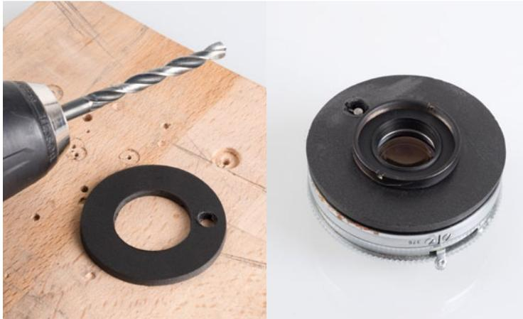
Da die Spannvorrichtung für den Verschluss bei der Retinette relativ weit außen liegt, kann man die dafür notwendige Aussparung nicht in einen M42-Kameradeckel integrieren, sondern muss eine Zwischenplatte aus Kunststoff anfertigen, an die ein Kameradeckel mit M42-Gewinde geklebt wird.
