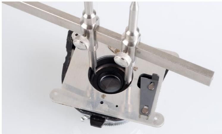
*Objektiv und Verschluss bilden eine kompakte Einheit und lassen sich mithilfe der Kontermutter an einer neuen Adapterplatte befestigen. Das rote Kabel dient der Blitzauslösung über die Synchronbuchse und wird nicht benötigt. (1) Spannvorrichtung für Verschluss, (2) Auslösehebel, (3) Kontermutter.*
