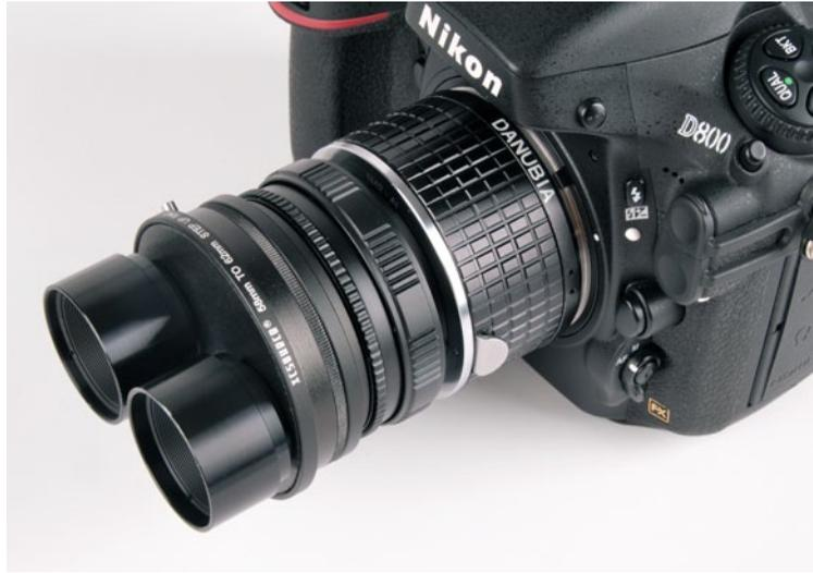
Zuerst wird die Aufnahmeplatte für die beiden Objektiv aus einer 3 mm starken Kunststoffplatte gefertigt. Eine Zeichnung mit den Maßen der Objektiv erleichtert das Übertragen auf die Platte. Diese Platte klebt man nun in einen Filteradapter von 58 mm auf 62 mm. Dann setzt man die Objektiv ein und fixiert sie mit Klebstoff. Im Grunde genommen ist damit auch schon die meiste Arbeit getan. Die restlichen Schritte dienen nur dazu, das Objektiv mit dem Helicoid bzw. mit der Kamera zu verbinden.
