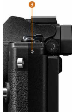
Abbildung 2.2: Sensorebene
