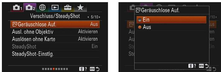
Abbildung 2.7: Ob Sie ein Verschlussgeräusch zulassen oder nicht, ist sicherlich Geschmackssache. Bedenken Sie aber, dass es bei abgeschaltetem mechanischen Verschluss bei bewegten Motiven zu Verzerrungen und Streifen auf dem Bild kommen kann.
