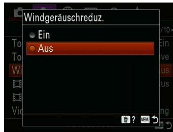
Abbildung 15.16: Stören Sie Windgeräusche bei der Aufnahme, wählen Sie bei der Option »Windgeräuschreduz.« die Option »Ein«.
