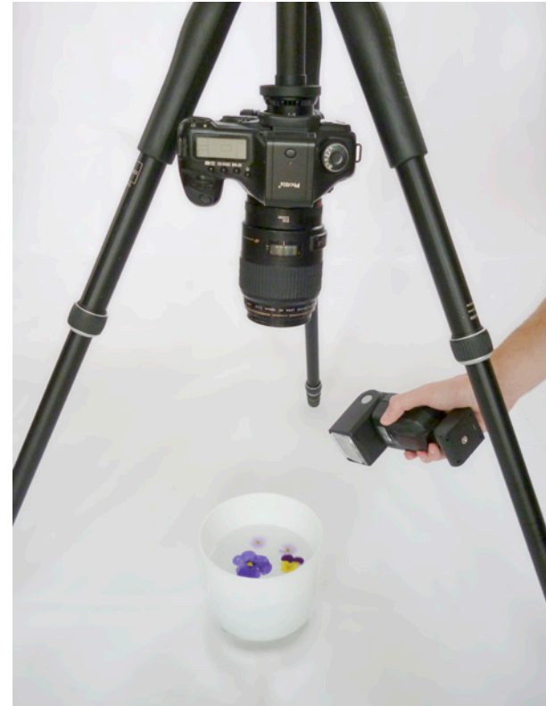
Um die Kamera von oben auf das Gefäß zu richten, wird die Mittelsäule des Stativs umgedreht. Das Blitzgerät wird mit der Hand ausgerichtet und per Funk ausgelöst.
