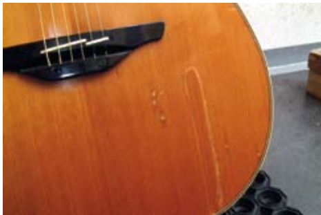
Abb. 3.2.1.1: Klarlacke sind oftmals eingefärbt und nur schwer zu reparieren
