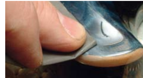
Abb. 3.2.1.10: Anschließender Nassschliff mit 2000er Papier
