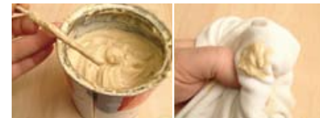
Abb. 3.2.1.12: Polierpasten enthalten Schleifmittel, mit denen feinste Kratzer entfernt werden können, bis der gewünschte Hochglanz erzielt ist
